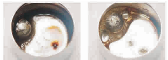
图11 无铅SnAgCu焊膏在300℃下加热,焊剂松香颜色的比较,反映了传统的与球窝焊膏的性能
